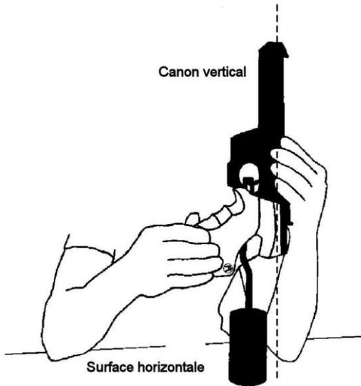
Le poids de détente doit être vérifié en plaçant le peson près du milieu de la détente – à l'endroit où se place l'index pour tirer - (voir illustrations) et en maintenant le canon vertical.
