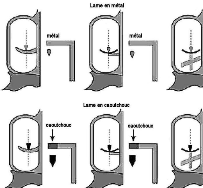
Un peson avec une lame en métal ou en caoutchouc, doit être utilisé.
